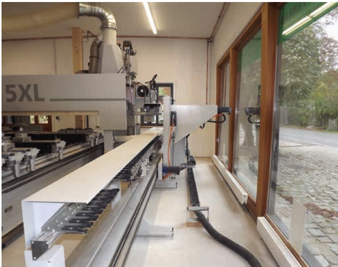
▲ Die Multirex verfügt über verschiedene vollautomatische Werkzeugwechsler, sodass sie Werkstücke komplettbearbeiten kann
